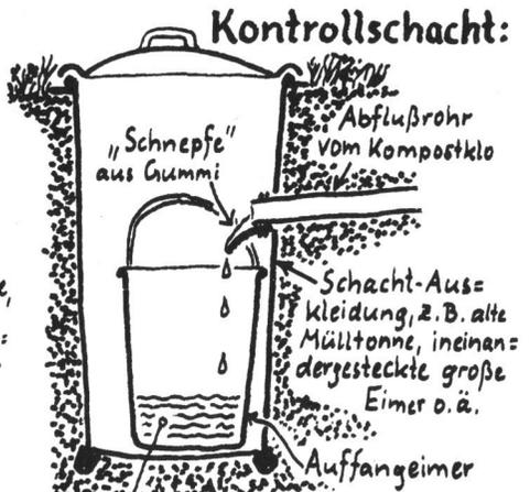
Flüssigkeit = konzentrierter Flüssigdünger, oder mit Einstreu gemischt ins Klo zurück, oder in einem Verdunster (s.S.17) fertigkompostieren.
