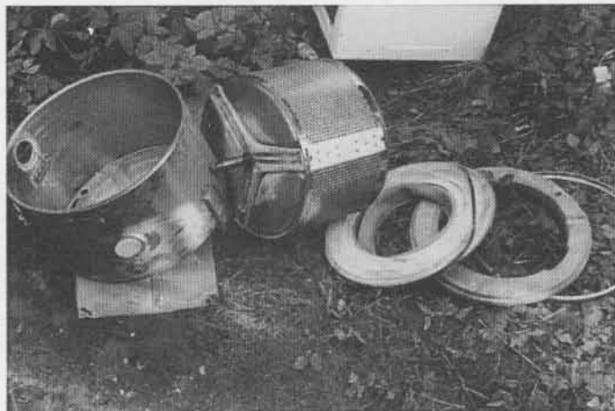
Verschlussring am Waschtrommelbehälter gelöst. Geöffnet, nach Abnehmen des Sprengringes Trommel mit Achse aus dem Lager gezogen.
