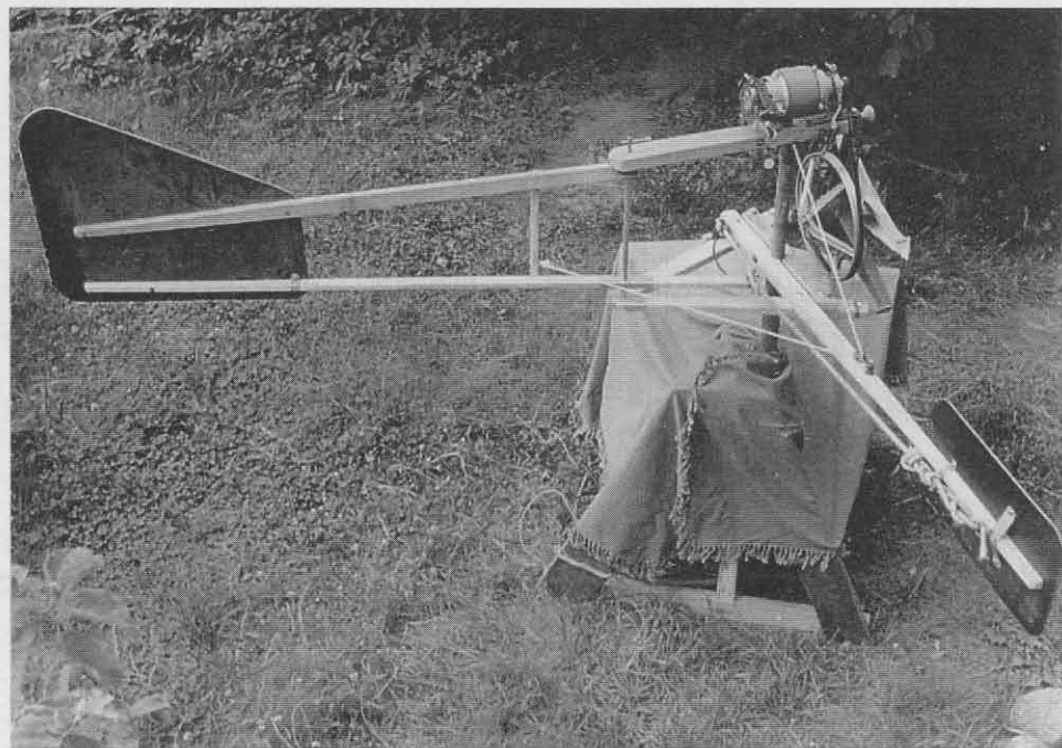
Das Flügelrad ↗ ↘ Rahmen mit Steuerfahnen, Generator, Getriebe.
