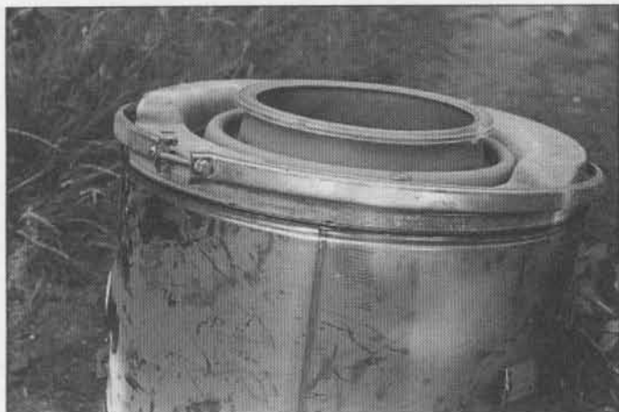
Verschlussring am Waschtrommelbehälter gelöst. Geöffnet, nach Abnehmen des Sprengringes Trommel mit Achse aus dem Lager gezogen.
