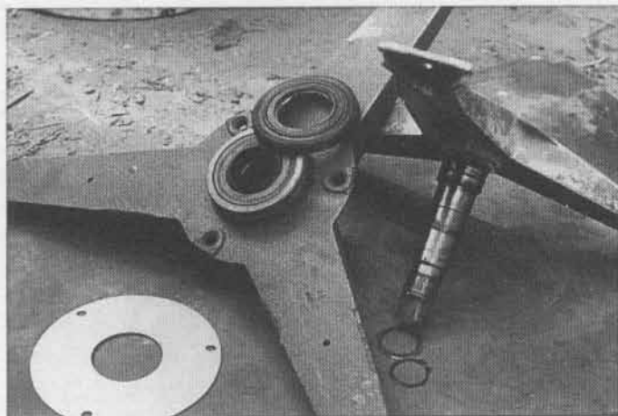
Lagergehäuse abgeschraubt, Trommel von der Achse abgebaut. Gummidichtung und Halteplatte aus Blech einzeln. Achse wieder eingebaut.
